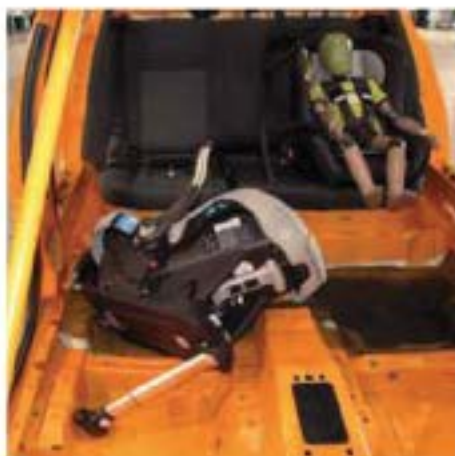
Sedačka Casualplay Baby Zero Plus s isofixovou základnou a figurínou jedenapůlročního dítěte před nárazovou zkouškou.
